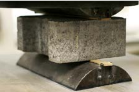
DLAŽBA PRI SKÚŠKE PEVNOSŤ V PRIEČNOM ŤAHU
