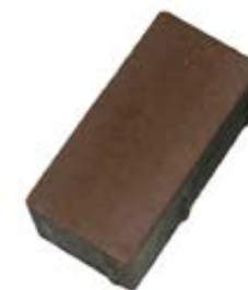
Povrch dlažby bez vápenného výkvetu
