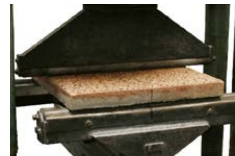
DLAŽBA PRI SKÚŠKE PEVNOSŤ V OHYBE
