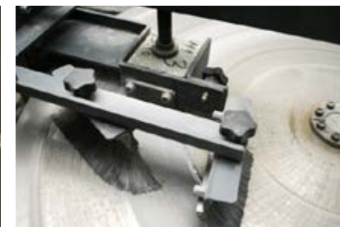
DLAŽBA PRI SKÚŠKE OBRUSNOSŤ POVRCHU
