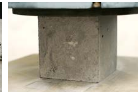
BETÓN PRI SKÚŠKE PEVNOSŤ V TLAKU
