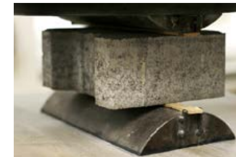
DLAŽBA PRI SKÚŠKE PEVNOSŤ V PRIEČNOM ŤAHU
