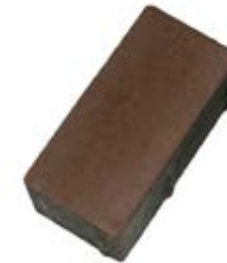
Povrch dlažby bez vápenného výkvetu
